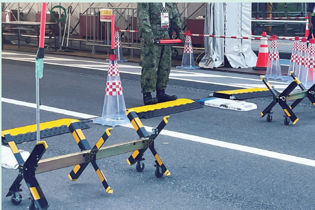
▲ 可搬式車両阻止アングル [P.6] + カラーコーン + コーンパー
